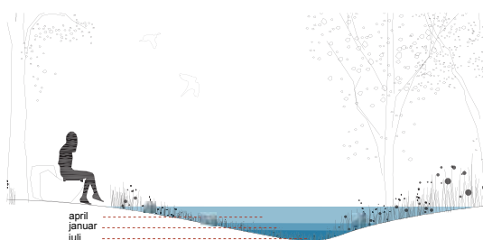
Vandet i byen - princip for synlig overfladevand som et tilskud til karakteren af byrum og fælles friarealer - her som en åben vadi på Søndre Havn.
