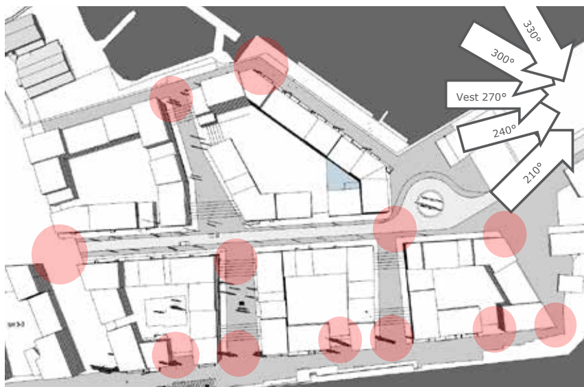
Illustration af vindmodel, der henleder opmærksomheden på udformning af hjørner og åbninger.
